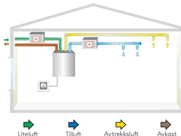
Uteluft      Tilluft      Avtrekksluft      Avkast
