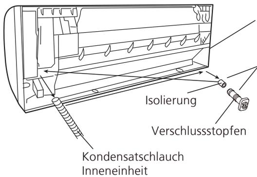
Zur Kondensatabfuhr nach links, Gehäuse vorsichtig mit einer Stichsäge an der Markierung ausklinken.
